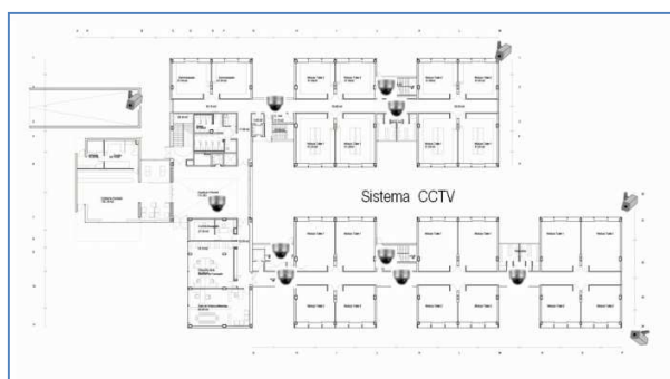
Cámaras de CCTV para la seguridad activa del Parque
